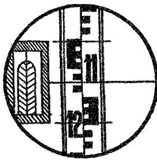
9. Снимите отсчет по вертикальному кругу теодолита
