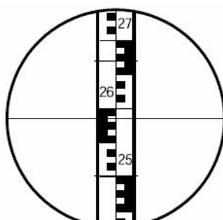
8. Определите расстояние от прибора до рейки
